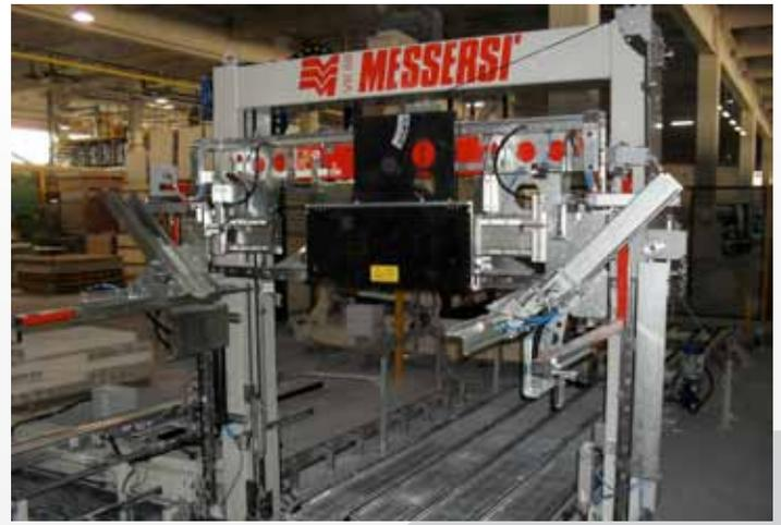
con dispositivo metti angolari, opzionale | with edge boards applicator, optional
