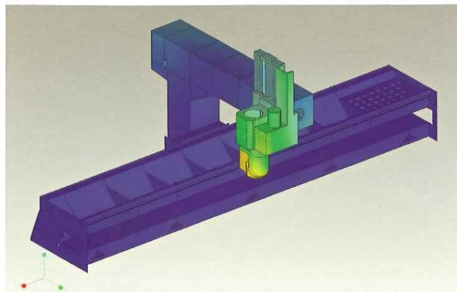
La nuova struttura completamente riprogettata con le più moderne tecniche CAD/CAM garantisce la massima rigidità che si trasforma in elevata qualità di finitura dei lavorati.
