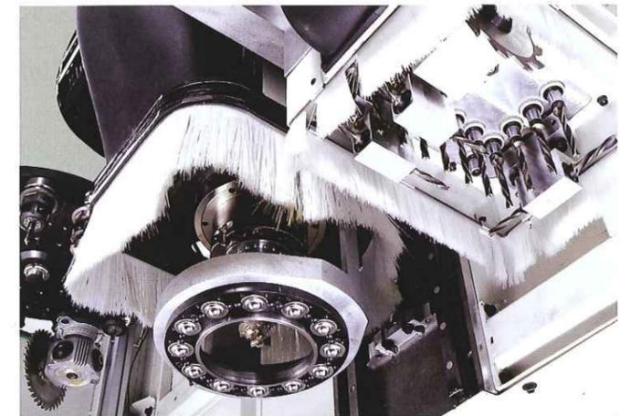
Pressatore meccanico con sfere, coassiale all'utensile, per ricavare da nesting anche pezzi di piccole dimensioni. La forza d'esercizio è regolata pneumaticamente.
