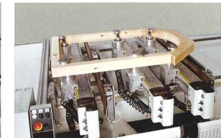
Mordazas con movimiento de rotación y traslación y alzadores de doble movimiento, permiten colocar fácilmente las hojas que se han de escuadrar.
