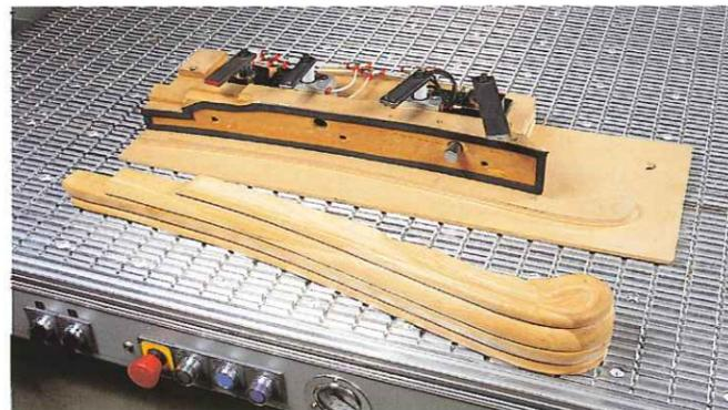
Il piano, direttamente lavorato sulla macchina, garantisce una assoluta precisione ed una perfetta planarità nel tempo, grazie alle sue caratteristiche di elevata rigidità. Ideale anche per lavorazioni di plastica, resine e leghe leggere.
