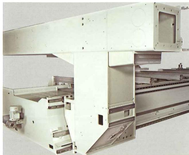
Basamento e montante mobile sono realizzati in carpenteria di acciaio elettrosaldato e stabilizzato con lamiere di grosso spessore ed opportune nervature di irrigidimento. Tutte le lavorazioni meccaniche vengono eseguite su centri di lavoro CNC in un unico posizionamento per garantire le rigorose tolleranze di planarità, perpendicolarità e precisione.
