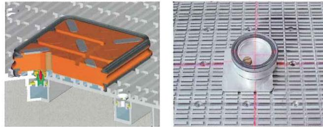
Una serie di fori filettati (passo 120 mm) offrono un'ancoraggio ideale per tutte le attrezzature di bloccaggio.
