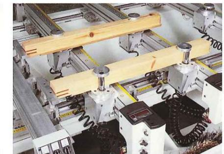
Per una produzione flessibile di finestre è necessario disporre di un sistema pratico, veloce ed intuitivo, che permetta di adattarsi in maniera rapida al variare delle dimensioni di ogni singola finestra. TVN SET è la piena risposta a questa esigenza. Attrezzato il piano con ventose o morsetti, al variare delle dimensioni del prodotto, è sufficiente modificare le quote nel programma parametrico e le barre si configurano per le nuove dimensioni.
