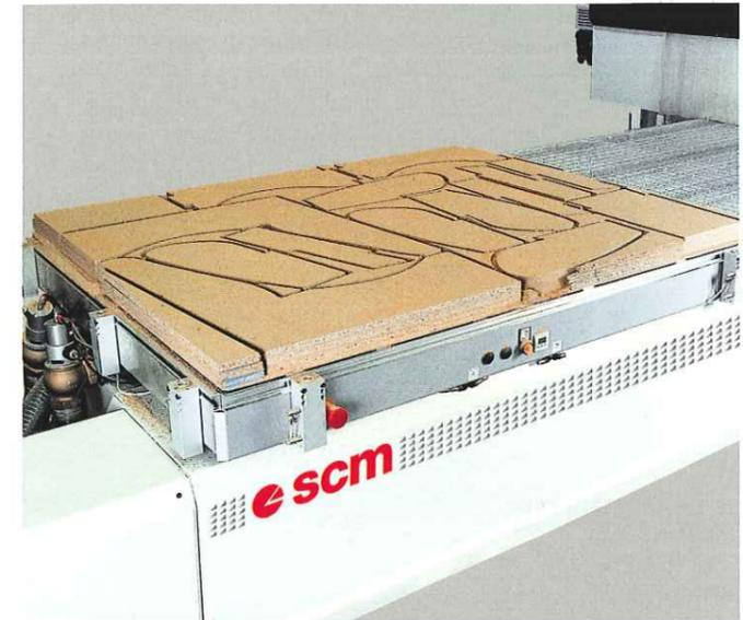
Una solida base d'appoggio in grado di offrire un'altissima capacità di vuoto: il piano ideale per un bloccaggio pezzi nella lavorazione in nesting. Caratterizzato dall'esclusivo profilo in alluminio, il piano garantisce totale stabilità nel tempo ed una portata di vuoto costante in ogni sua zona.
