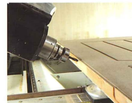
Prisma permite utilizar la misma herramienta en posición horizontal, vertical o en planos inclinados, esto elimina todos los módulos agregados, reduce la necesidad de cambiar de herramienta y agiliza la producción.
